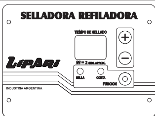
Fig. N° 1 PANEL DE: "SELLADORA REFILADORA"
